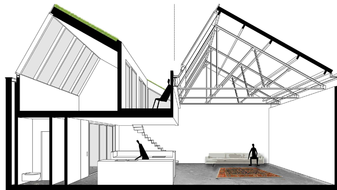
Gedeelte woning aan achterkant met bestaande staalconstructie. Dak van stalen golfplaten zoals bestaand.
