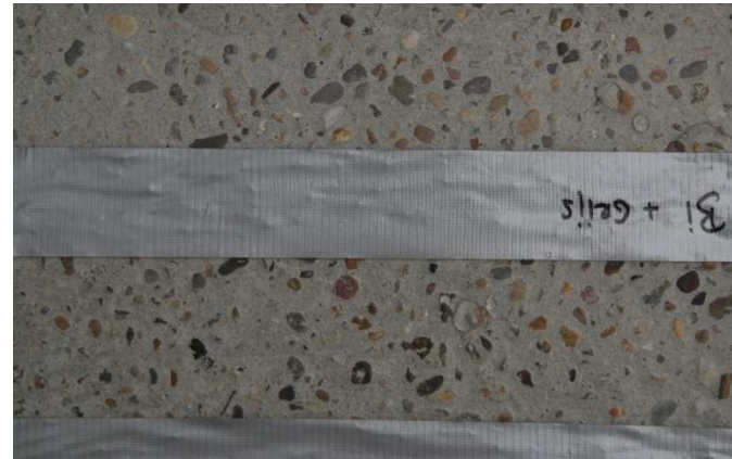
Een fragment van een kleurenproef. De onderste strook is een hydrofobeerlaag zonder kleurtoeslag, de bovenste strook is een hydrofobeerlaag met een kleur toeslag (lichtgrijs).
