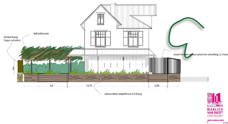
doorsneden | definitief ontwerp tuin Wichmanlaan | schaal 1:100 | december 2017
