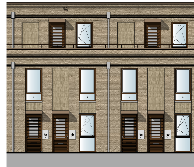
Gevelfragment spoorzijde. De woningen op de begane grond en 1e verdieping hebben allemaal een eigen voordeur aan de straat. De woningen op de 2e verdieping hebben een galerij met ontsluiting.
