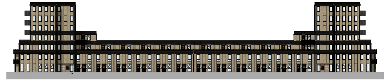
Gevel spoorzijde met de galerijontsluiting op de 2e verdieping in het middendeel.
