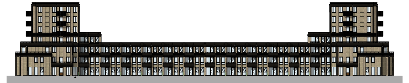
Gevel hofzijde. De gevel is geleed met balkons en verspringende bouwmassa's.
